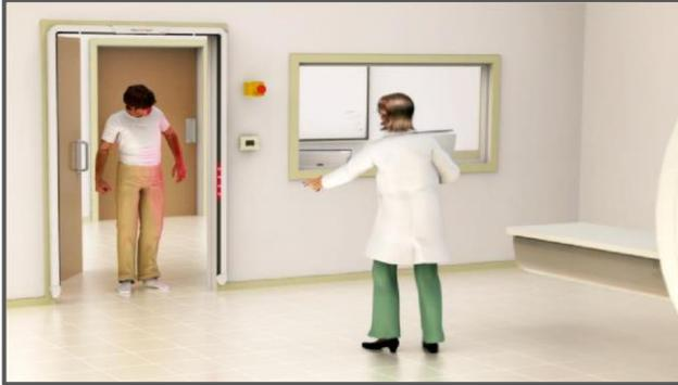
*Allarme e localizzazione dell'oggetto ferromagnetico su un paziente che sta entrando nel locale di risonanza magnetica. I led di localizzazione sono su entrambi i lati del portale e identificano la posizione dell'oggetto.*
