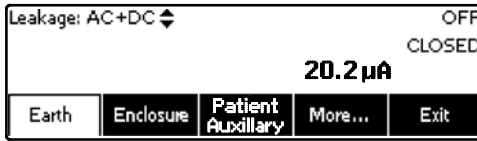
Figura 18. Menu principale del test della corrente di dispersione
